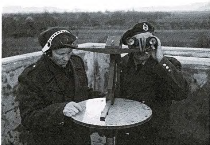
Luchtwachters op de uitkijk op een toren elders in het land, 1955. Onderdeel van het luchtwachtinstrument is de ronde kaart met coördinaten van de omgeving. De man met de headset staat per telefoon in verbinding met het luchtwachtcentrum. Bron KLu in particuliere collectie.
