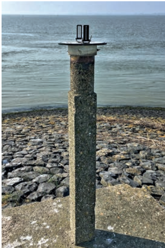
Pelorusopstand (mudpaal) Kruijningen aan de Westerschelde. De pelorus erop is uit 1958 met een breed keepvizier. Foto S. van Lochem 2018.
