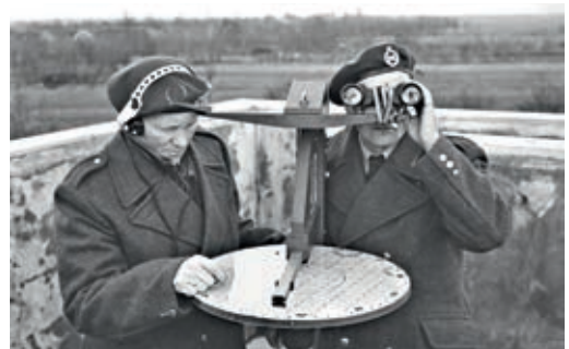
Luchtwachters op de uitkijk, 1955. Onderdeel van het luchtwachtinstrument is de ronde kaart met coördinaten van de omgeving. Bron KLu in particuliere collectie.
